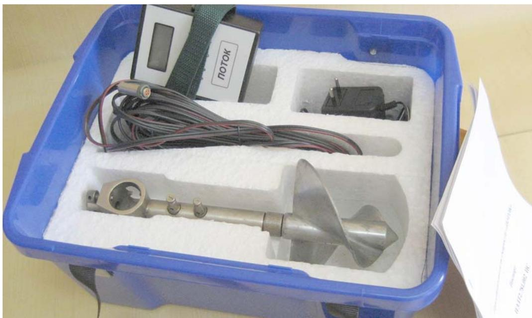
Внешний вид прибора в с вертушкой в пластиковом ящике (крышка снята)
